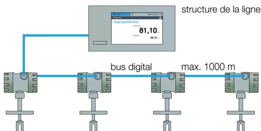
Contrôleur avec connexion de quatre sondes au maximum
