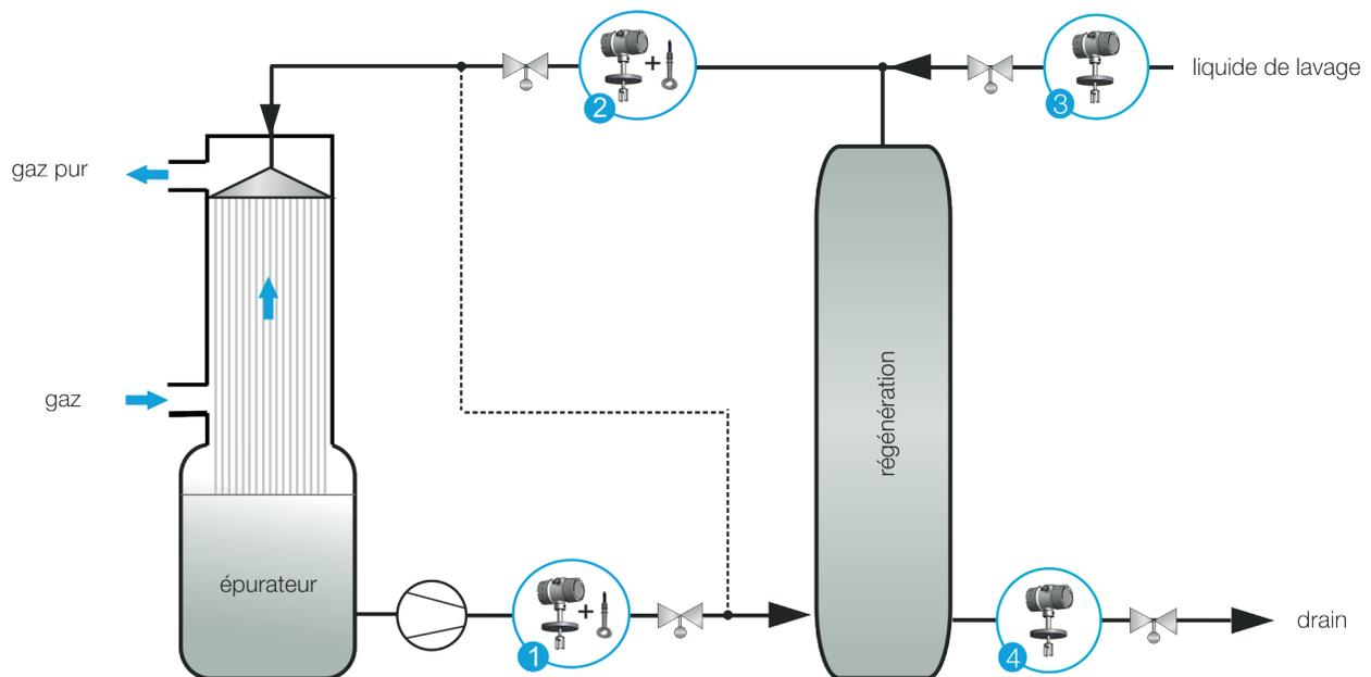
Processus d'absorption des gaz dans un laveur à jet
