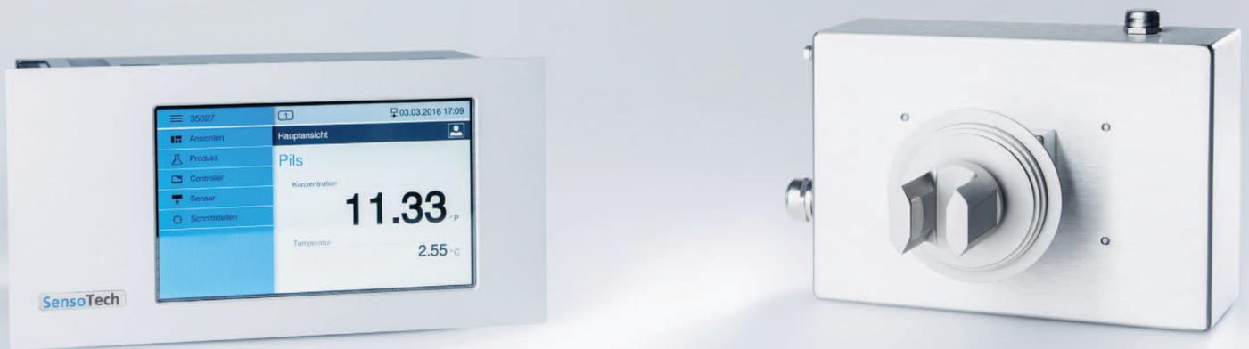
LiquiSonic® ist ein auf modernsten Technologien basierendes Inline-Analysensystem. Durch die präzise und temperaturkompensierte Messung der absoluten Schallgeschwindigkeit lässt sich die Konzentration von verschiedenen Flüssigkeiten, wie der Gehalt von Stammwürze, Trockensubstanz, Alkohol oder °Brix, bestimmen.
