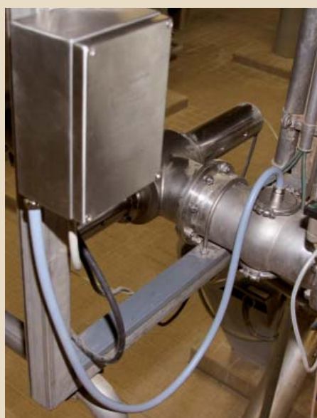
Fig. 1 Measuring point on the lauter tun in Warsteiner Brauerei
