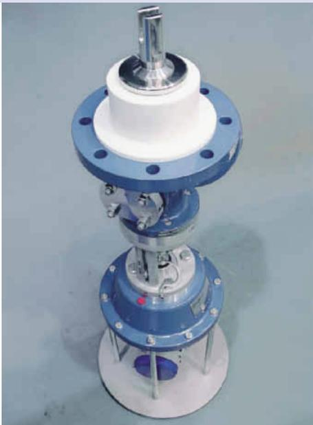
*Das Bodenablassventil mit integriertem Liquisonic-Sensor wird zur Echtzeit-Reaktionsüberwachung im laufenden Prozess eingesetzt*
