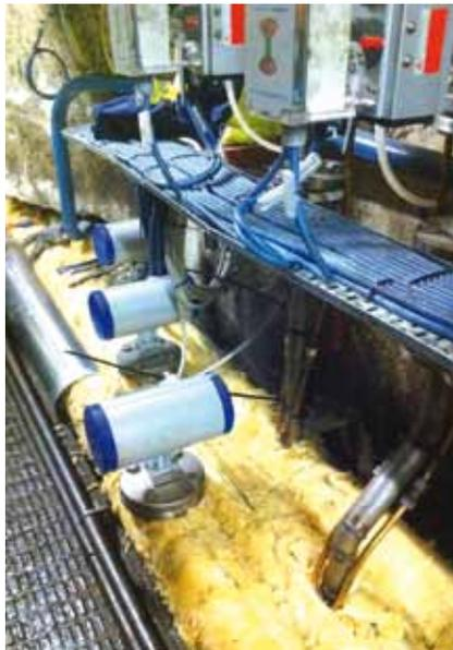
**Messstelle in einer Tandemstraße mit drei LiquiSonic-Tauchsensoren installiert in drei isolierten Rohrleitungen.** Bilder: SensoTech
