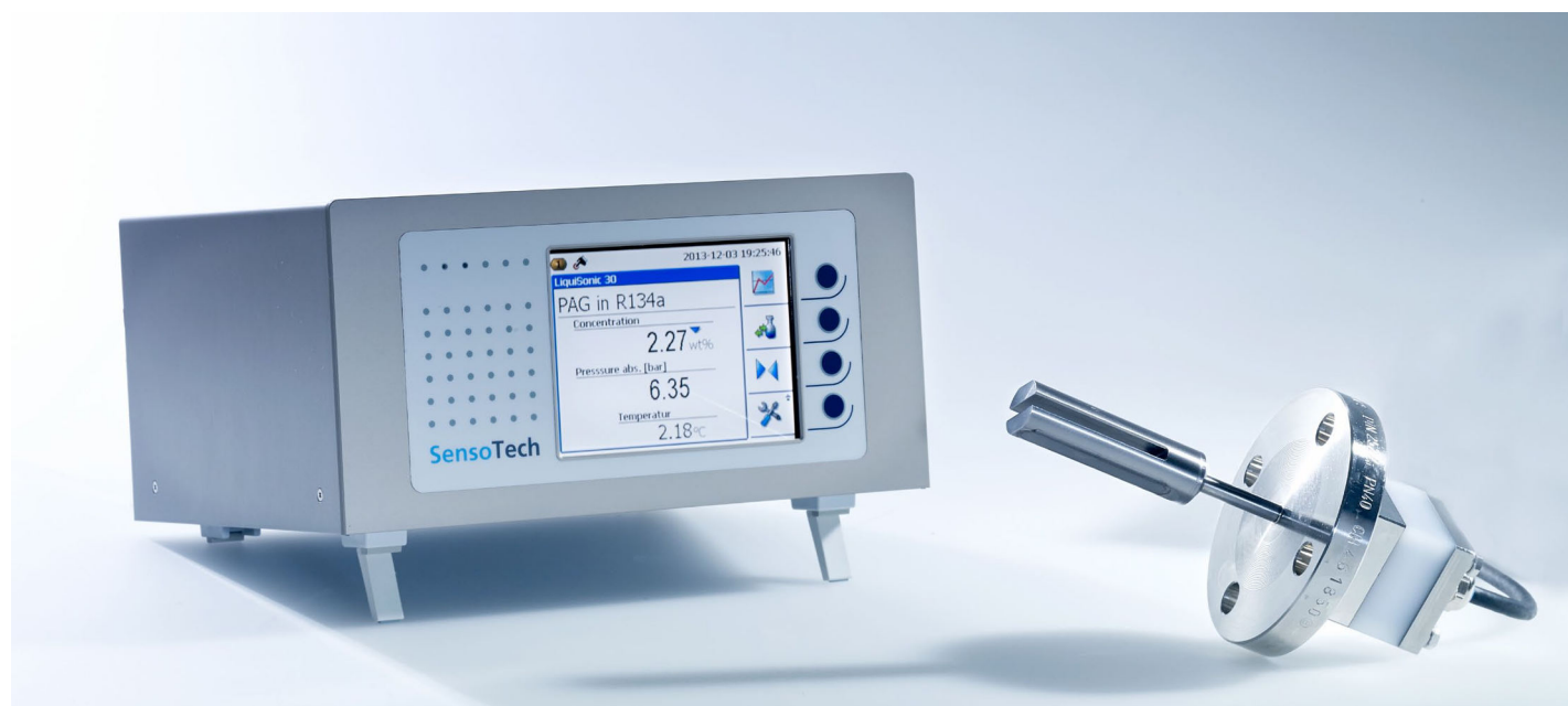
Bild 1: Das „LiquiSonic“-Messsystem von SensoTech misst präzise und kontinuierlich den Ölgehalt im Kältemittel.
