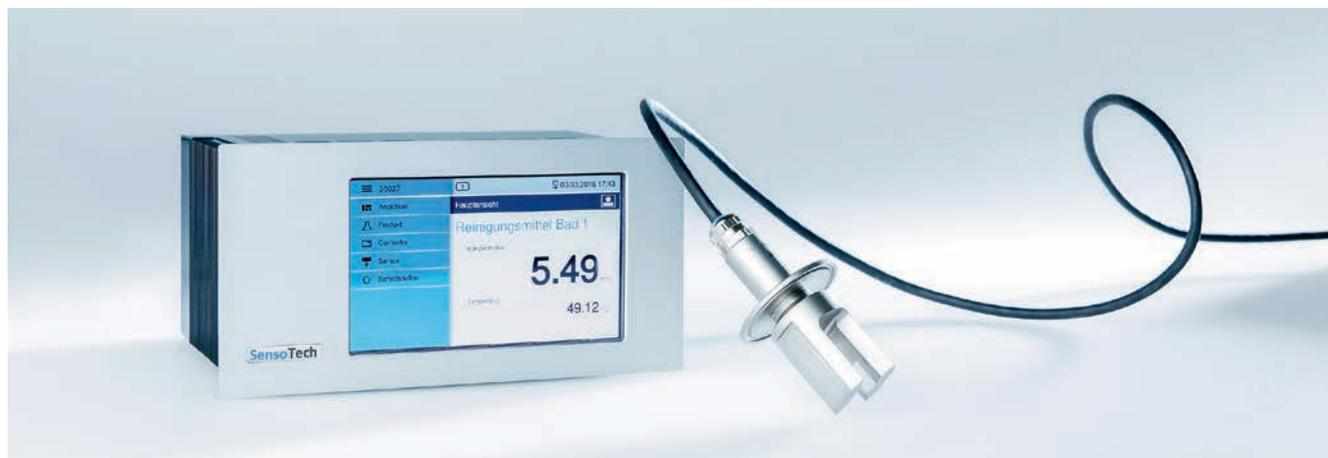
Zur sicheren Überwachung des Reinigungsprozesses misst das Analysesystem kontinuierlich die Reinigerkonzentration im Bad, so dass vordefinierte Grenzen weder unter- noch überschritten werden.
