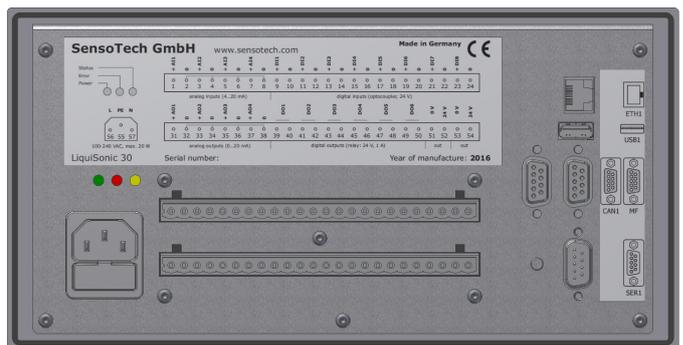
带电气连接的控制器背面
