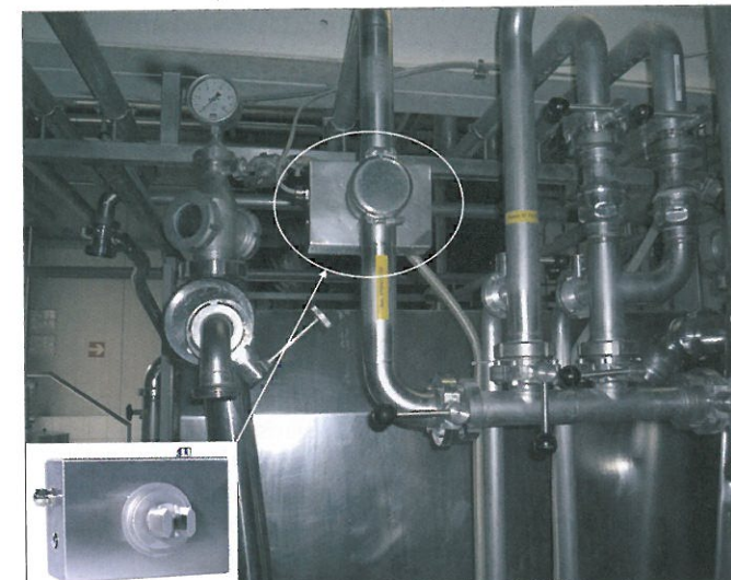
Liquisonic-Plato-Messstelle am Bierfilterausgang der Colbitzer Heidebrauerei
