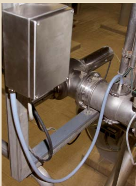
Abb. 1 Messstelle am Läuterbottich der Warsteiner Brauerei
