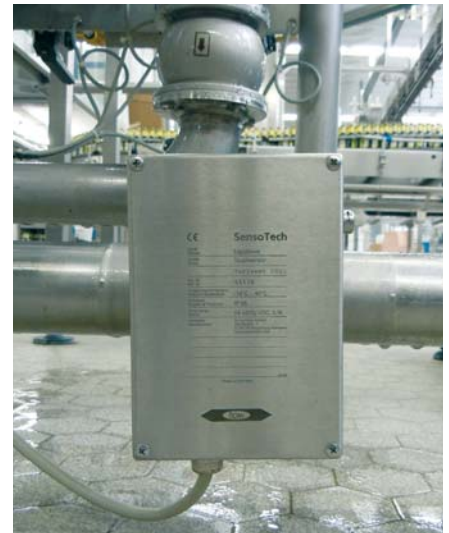
Am Füller misst der Sensor kontinuierlich den Plato- oder Brixgehalt von insgesamt 30 Produkten während der Abfüllung.
